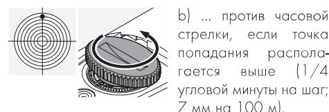
4. Боковая коррекция: установочным инструментом поверните в центре механизма боковой коррекции...
