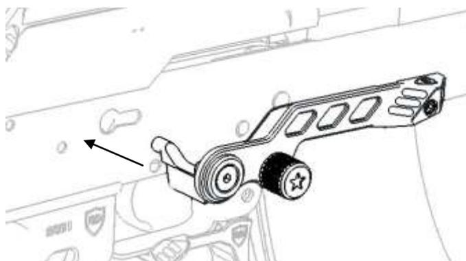
На все резьбовые соединения уже нанесён синий фиксатор резьбы.
